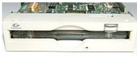
Рисунок 1.5 – Внутренний привод магнитооптических дисков с диском внутри
