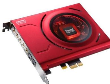
Рисунок 1.4 – Звуковая карта (звуковая плата, аудиокарта, аудиоплата)
