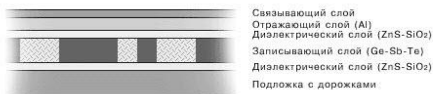
Рисунок 1.7.3 – Послойная структура одной половины DVD-диска
